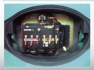
L'impianto elettronico ZAPI AC di ultima generazione ed i potenti motori in corrente alternata adeguatamente dimensionati consentono di lavorare alle massime prestazioni sia in piano che in rampa.
