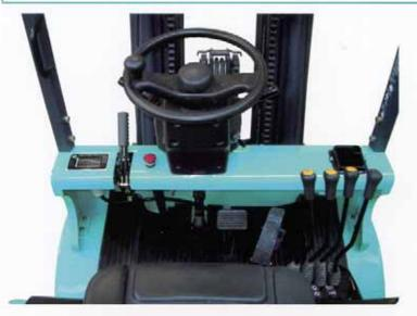
L'operatore, grazie al volante regolabile in altezza ed inclinazione, grazie all'ottima disposizione delle leve di comando accanto al sedile di guida ed al vano piedi ampio e ben dimensionato, può lavorare confortevolmente ed in totale sicurezza.
