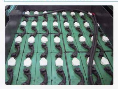
La batteria di trazione, di tecnologia europea, a piastre corazzate e con elementi imbullonati offre, oltre ad un moderno design, una manutenzione facile ed una garanzia di lunga durata nel tempo.
